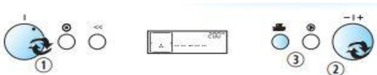
1. Stellen Sie den Funktionsschalter auf die Vorwärme-Funktion
